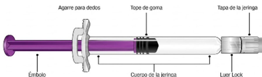
Figura 1. Componentes de la jeringa Luer Lock
