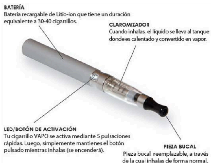
Figura 12: Detalle de un cigarrillo electrónico convencional
